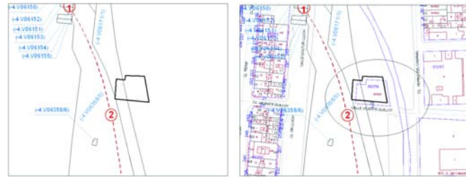
Figura 2. Detección de errores de exactitud posicional
