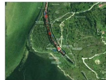
Figura 3. Detección de errores de georreferenciación utilizando el servicio WMS del Plan Nacional de Ortofotografía Aérea (PNOA).
