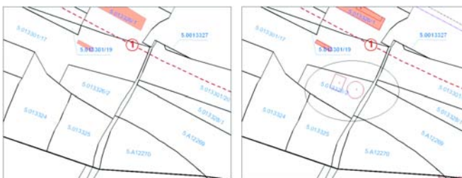
Figura 1. Detección de geometrías no digitalizadas gracias al servicio WMS de la Dirección General de Catastro integrado en la Infraestructura de Datos Espaciales de España (IDEE).
