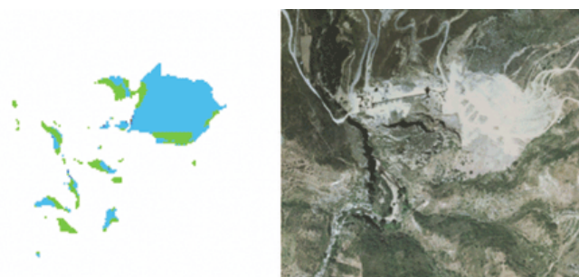
Figura 5. Error de representación en el MDE debido a modificaciones reales en el terreno.
